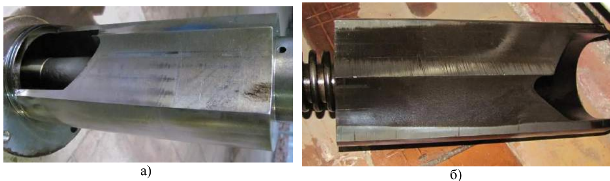
Рис. 3. Состояние золотника: без повреждений (а); со следами задевания роторов (б)
