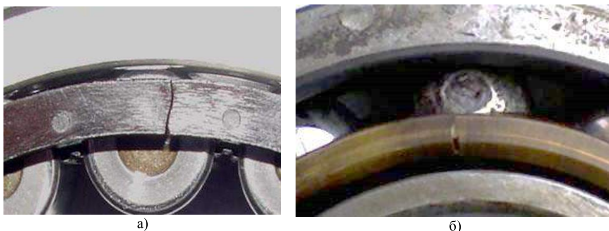
Рис. 4. Осмотр подшипника: а) трещина сепаратора; б) повреждение тела качения
