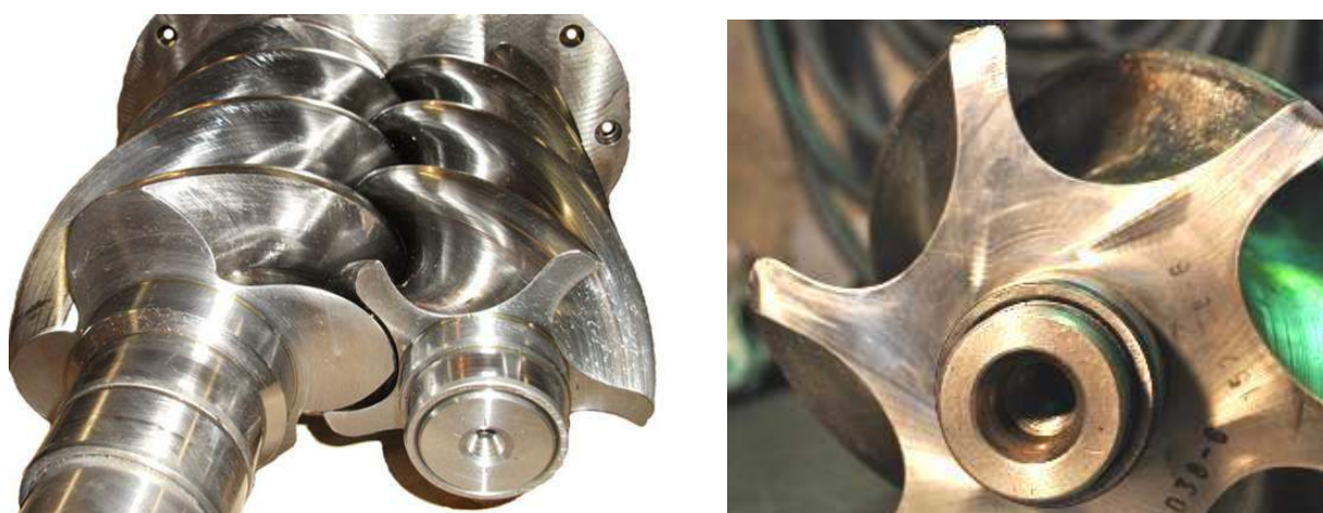
Рис. 2. Рабочий орган винтового компрессора – винты
