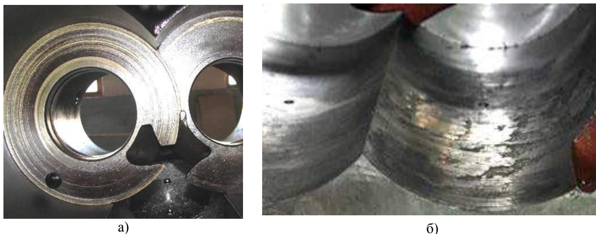
Рис. 6. Повреждения корпуса: а) износ поверхности задней крышки; б) износ цилиндрической поверхности корпуса
